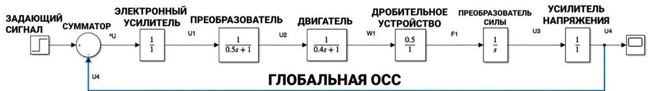
Рисунок 2.2 – Структурная схема замкнутой системы контроля энергодиспетчеризации дробительного отдела
